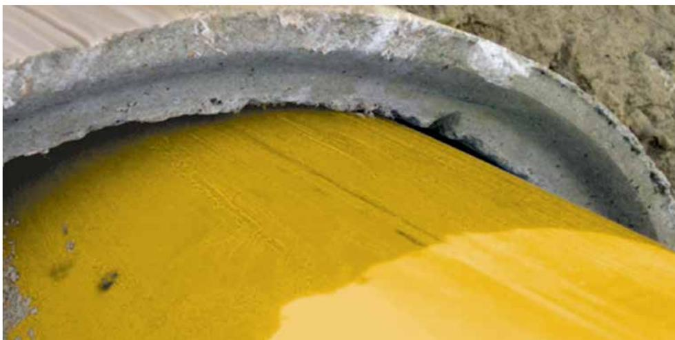
На фотографии видно, что при монтаже и прокладке трубопровода механические повреждения остаются на защитной оболочке ПРО не влияя на основную трубу.
