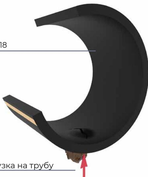
Точечная нагрузка на трубу
