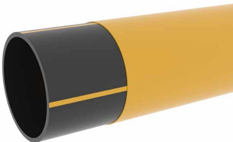
Внутренняя поверхность защитной оболочки ПРО и наружная поверхность основной трубы не имеют между собой адгезионной связи, что позволяет на необходимых для монтажа участках трубы относительно легко удалять защитное покрытие.
